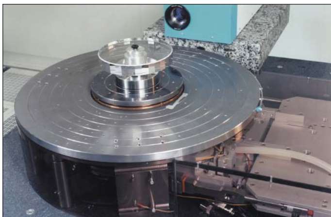
Компаратор угла, шаг измерения ок. 0,001"
