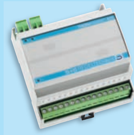
THERMASGARD® 9111 с 8 аналоговыми пассивными входами
