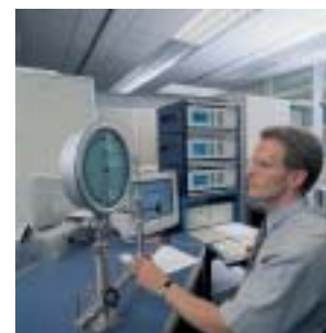
Механические и электрические измерительные приборы калибруются на фирме WIKA в DKD - калибровочной лаборатории
